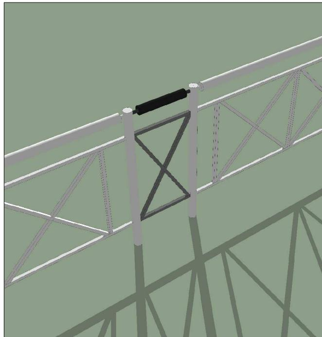
Estos elementos deben ser colocados en forma simétrica y centrada entre los elementos contiguos. Las barras entrecruzadas se deben colocar en contacto con las barras horizontales, independientemente del ángulo que se genera entre ellas.
